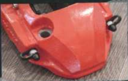
内側と外側の境目がなく、ボルトでの固定も見られないのがモノブロックキャリパーの証。ブレーキング時に開く方向に力が逃げにくい特徴を持つ。
