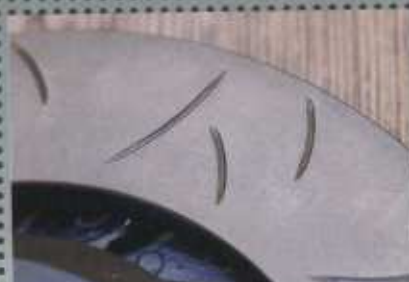
錆びやクラックの発生リスクが少なく、それでいて放熱性に優れるスリットタイプを採用したローター。スリットの入り方が独特だ。
