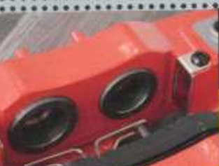
対向4ポットピストンのキャリパー。大径ホイールに対してのブレーキ強化であることを踏まえると、これで十二分な能力といえる。
